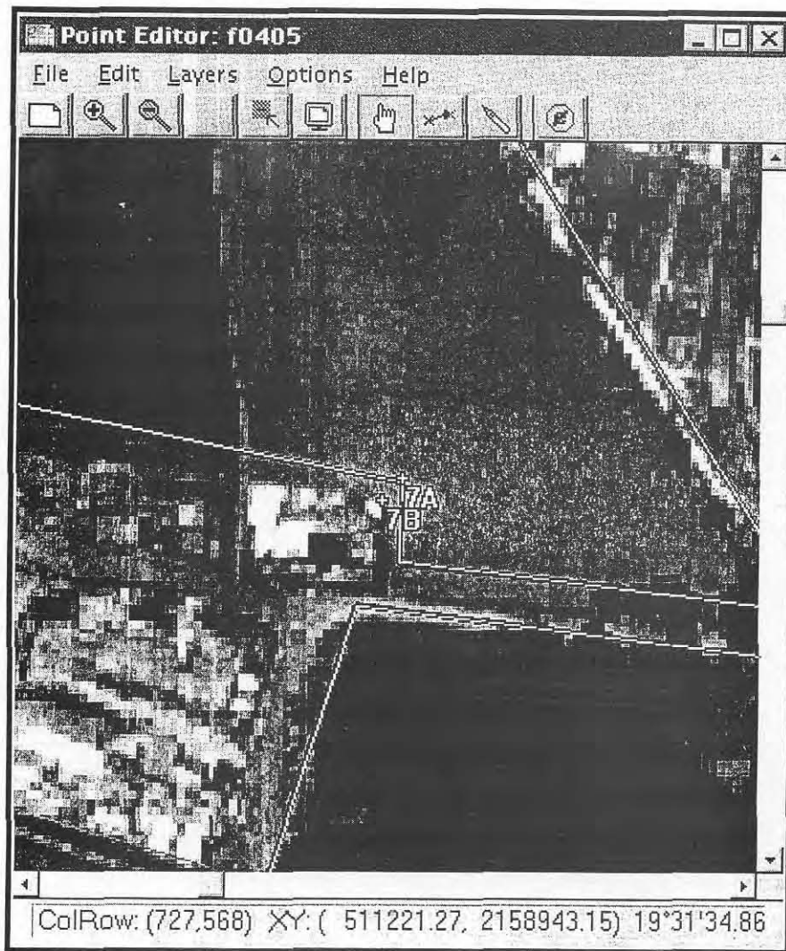
Figura 2. Ejemplo del desplazamiento que existe entre la posición de un segmento digitizado de la cartografía de comparación (a escala 1:10 000) y su correspondiente rasgo.
