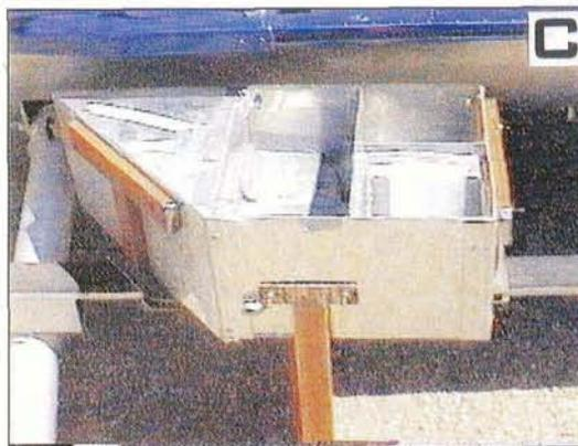
**Figura 2.** En A se muestra el helicóptero empleado para realizar los registros de las imágenes. En B se notan las dimensiones del soporte de aluminio en donde se colocaron las cámaras de video y fotográfica. En C se aprecia el diseño para sujetar la montura metálica en la estructura inferior del helicóptero, y los detalles de los compartimientos para la instalación de las cámaras.
