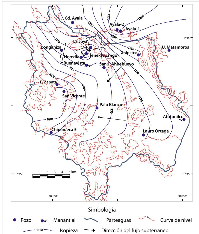
Figura 4. Configuración de la dirección del flujo subterráneo.
