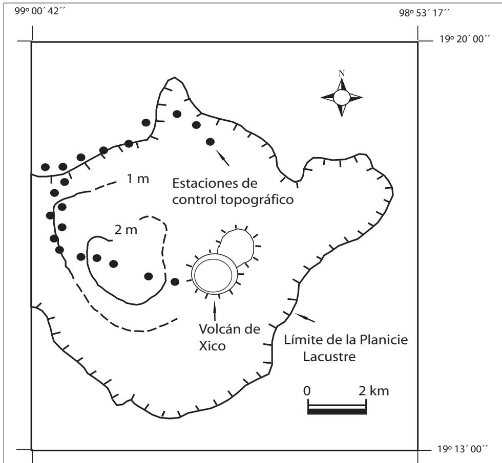
Figura 3. Deformación vertical del terreno en el periodo de 1984 a 1989, en respuesta al bombeo de los catorce pozos del Sistema Mixquic-Santa Catarina (modificado de Ortega *et al.*, 1999). Los hundimientos máximos corresponden con los mayores espesores del paquete lacustre (Figura 2a).
